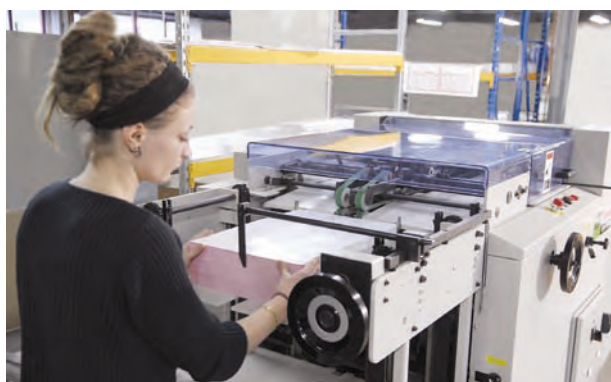
La maîtrise complète de la chaîne de fabrication (perforation automatique)
